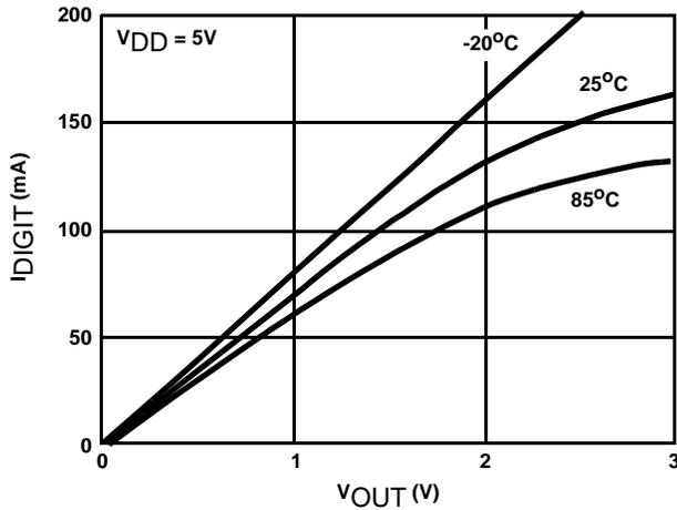
FIGURE 4. TYPICAL I<sub>DIGIT</sub> vs V<sub>OUT</sub>
