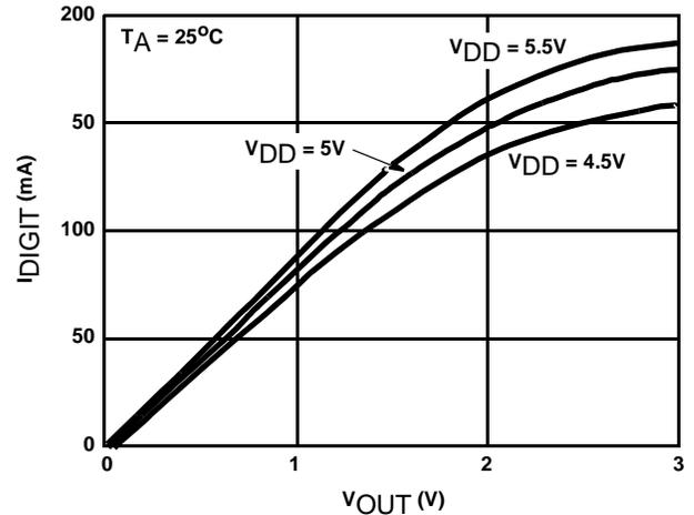
FIGURE 5. TYPICAL I<sub>DIGIT</sub> vs V<sub>OUT</sub>
