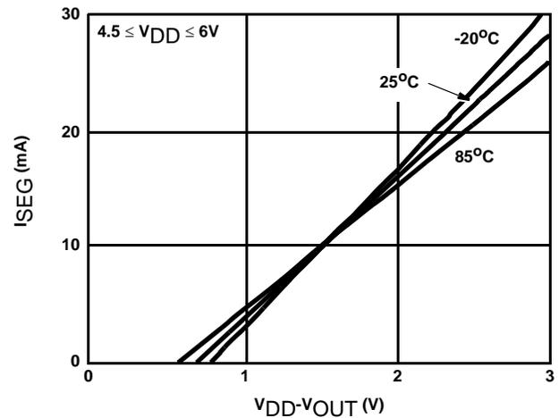
FIGURE 3. TYPICAL I<sub>SEG</sub> vs V<sub>DD</sub>-V<sub>OUT</sub>
