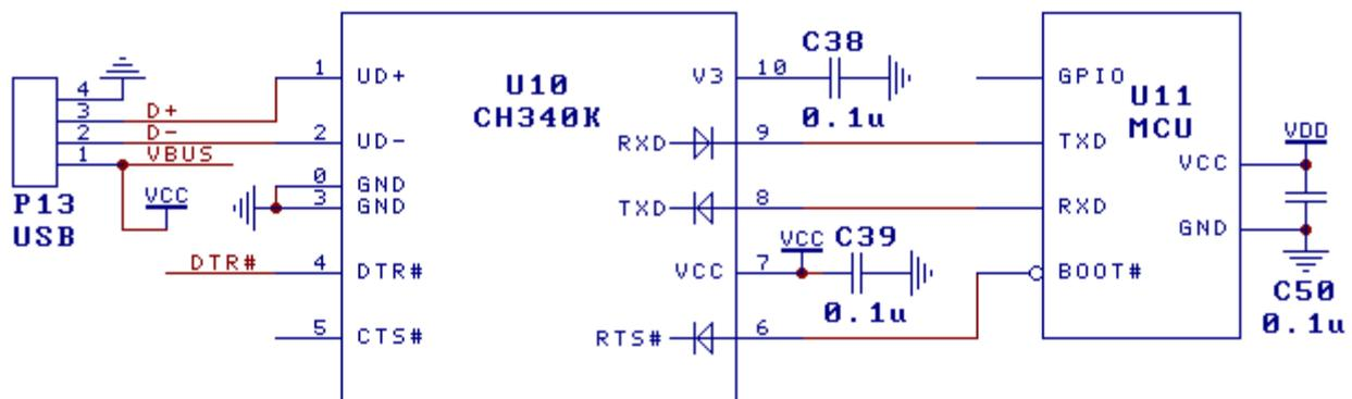
上图是双供电方式下 MCU 单片机通过 TTL 串口连接 CH340K 芯片实现 USB 通讯的参考电路。CH340K 由 USB 总线供电 VBUS (VCC)，MCU 使用另一电源 VDD，VDD 支持 5V、3.3V 甚至 2.5V、1.8V。CH340K 封装的底板是可选 GND 引脚，根据 PCB 走线方便选择连接 GND 或者悬空。
