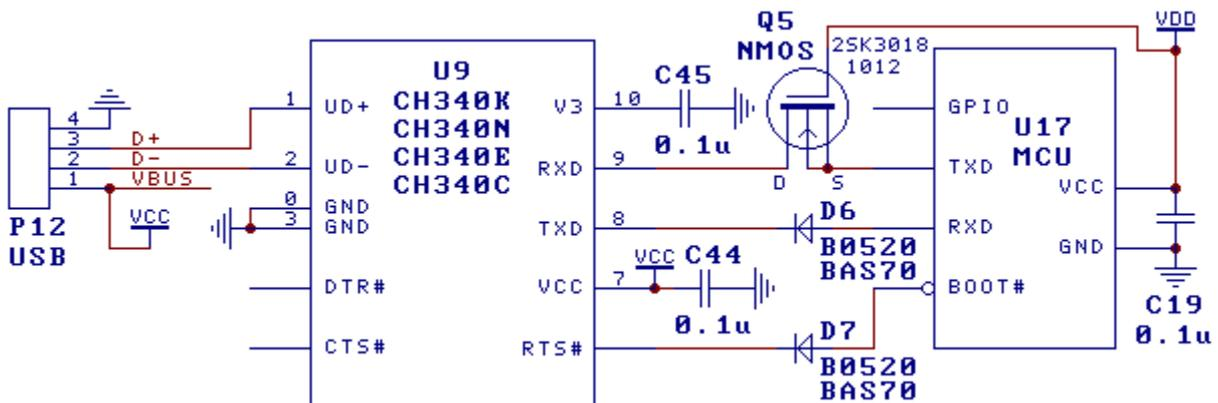
上图是双供电方式下 MCU 单片机通过 TTL 串口连接 CH340 芯片实现 USB 通讯的参考电路。CH340 由 USB 总线供电 VBUS，MCU 使用另一电源 VDD，VDD 支持 5V、3.3V 甚至 2.5V、1.8V。
